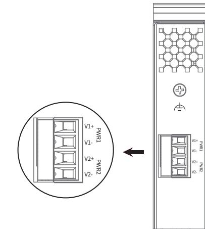
1. 将正/负DC线插入接线端子的V+/V-端子。
