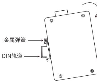
2. 将交换机迅速旋转按入DIN导轨, 如下图所示位置。
